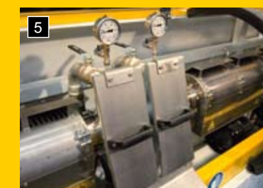
5 Простая дегазация с двумя эксплуатационными крышками
