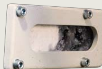
Смотровое окно/ доступ для техосмотра на конвейере
