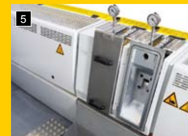
Простая дегазация с двумя эксплуатационными крышками
