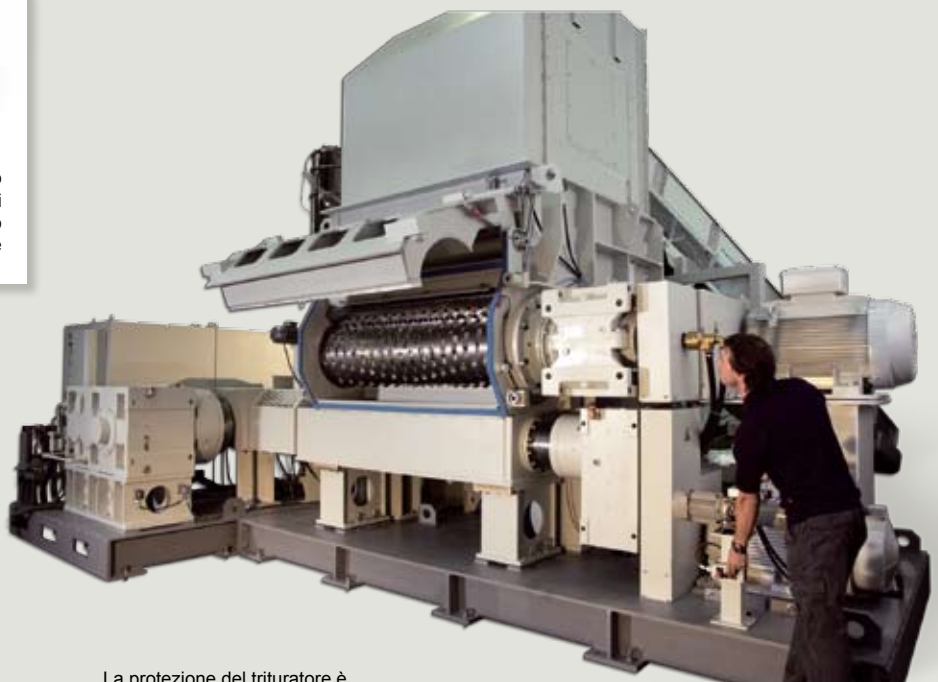
La protezione del tritratore è incernierata e apribile idraulicamente.
